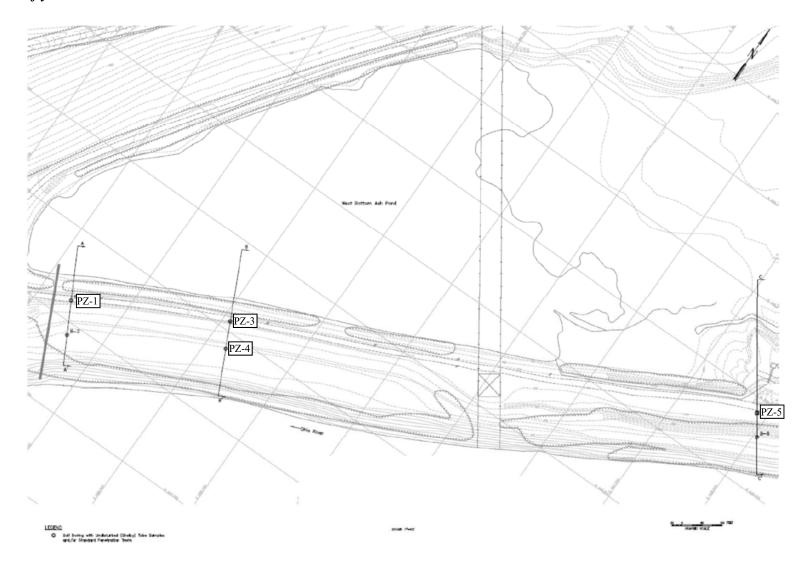
FIGURE 1. WEST BOILER SLAG POND PIEZOMETERS LOCATION PLAN
